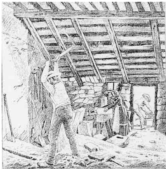
Gennem Aarhundreder brød man Limsten ved Bulbjerg og Thorup og gjorde den anvendelig til Bygningsbrug. Her ser vi Limstenen blive tildannet – en særpræget Industri, der ikke mere findes i Vester Han Herred.
