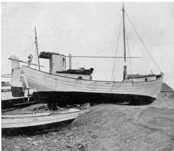
Kutter paa Stranden ved Slettestrand. Havbaaden "Lydia", bygget 1925 i Hvorupøre. En typisk Repræsentant for den forholdsvis lille Kutter, der afløste den gamle, aabne Robaad. Som den er den beregnet til Fiskeri fra aaben Kyst. (Nationalmuseet fot.)
