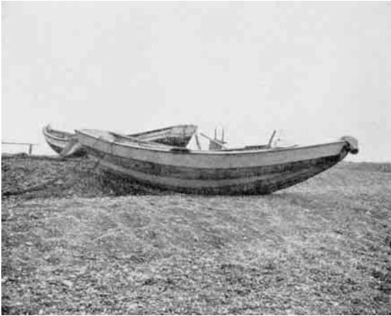
Norske Pramme paa Stranden. Baadenes buede Form uden Køl gør dem fortrinligt egnede til at lande paa aaben Strand. Slettestrand, Vester Han Herred. (Nationalmuseet fot.)
