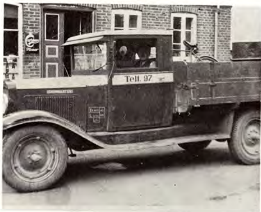
Slagter Oxsenbølls varevogn, Chewrolet 1928/29, på nær motorhjælm og skærme opbygget på karetmager Krogsgaards værksted.
