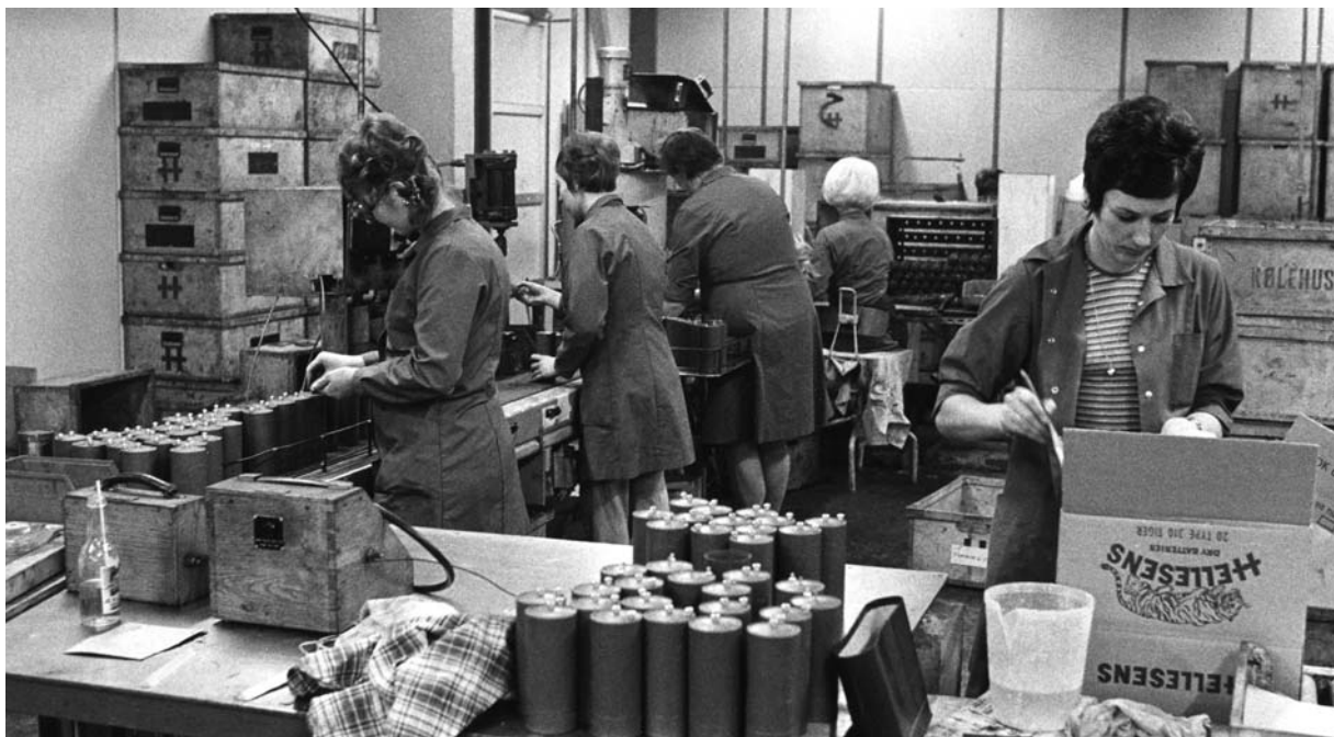
Fra HelleSENS fabrik i Thisted 1973. Der monteres og testes batterier. Fotograf: Tage Jensen, Thisted. Elmuseets arkiv.
