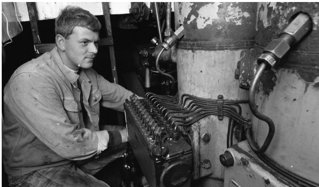
Preben Pedersen i motorrummet på »Niels Juel«. Til højre ses de to motorcylindre med brændstofførslerne. Lige over Prebens venstre arm ses håndtaget, hvormed man sætter trykluft på cylindrene, så stemplerne sættes i gang. Det er smørekassen med de mange rørledninger, man ser i forgrunden.
