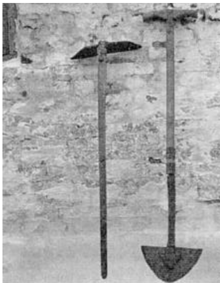
Fig. 16. Til venstre Ovnrageren, "Æ Raa:g". Bladet paa dette Eksemplar er af Jern, men der fandtes ogsaa Ovnragere, hvor Bladet var af Træ. Til højre en Tørvespade.
